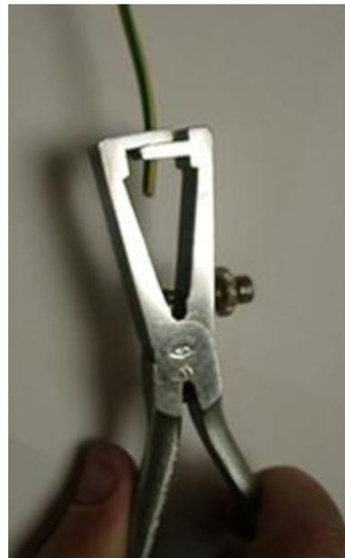
Une fois le conducteur dénudé ,il faut le repérer à l'aide de repère(autocollant(autocollants, enfilés, ....) en fonction du schéma.
