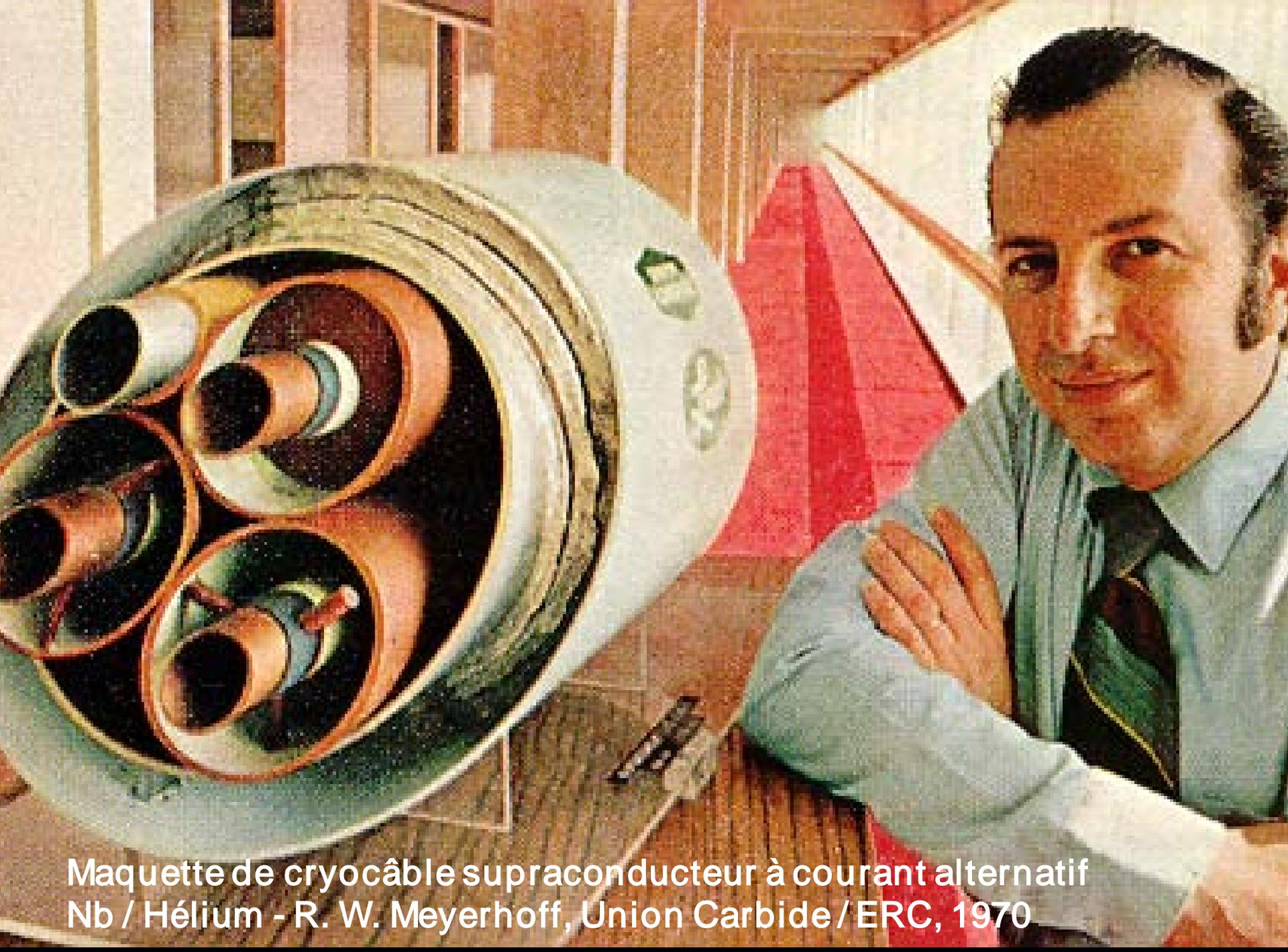
Maquette de cryocâble supraconducteur à courant alternatif
